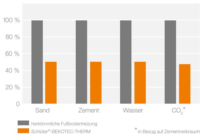
Der intelligente Konstruktionsaufbau reduziert den Materialeinsatz und spart somit Ressourcen und CO<sub>2</sub>-Emissionen. Der CO<sub>2</sub>-Ausstoß, der auf den Zementverbrauch zurückgeht, beträgt bei BEKOTEC-THERM maximal 10,5 kg/m<sup>2</sup> im Vergleich zu 23,8 kg/m<sup>2</sup> bei herkömmlichen Fußbodenheizungen. CO<sub>2</sub> wird auch durch die hohe Energieeffizienz des Systems gespart.
